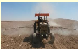
استفاده از سمپاش پشت تراکتوری بومدار
